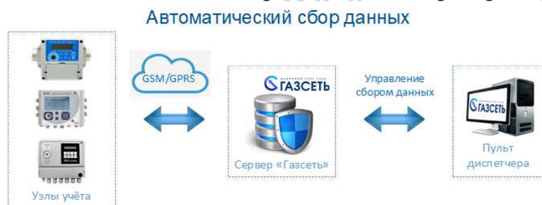
Рис. 1. Схематичное представление системы автоматического сбора данных
