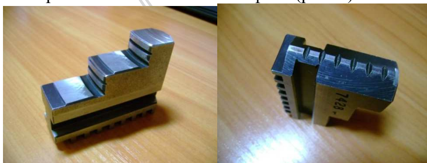
Рис. 5. Распространенная форма рабочей поверхности кулачка токарного патрона при зажатии детали за внутренний и наружный диаметр заготовки
