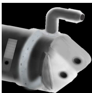
Рис. 5. Рентгенограмма сварного шва в месте соединения «Цилиндра» с
