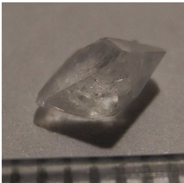
Рис. 1. Кристалл тартрата кальция, выращенный из геля на основе желатина.
