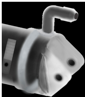
Рис. 7. Рентгенограмма сварного шва в месте соединения «Цилиндра» с «Крышкой» после ремонта
