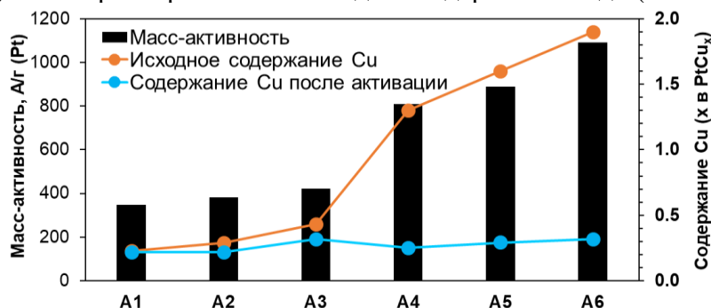
Рис. 1. Масс-активность в РВК и содержание меди до и после электрохимической активации в PtCu/C материалах.
