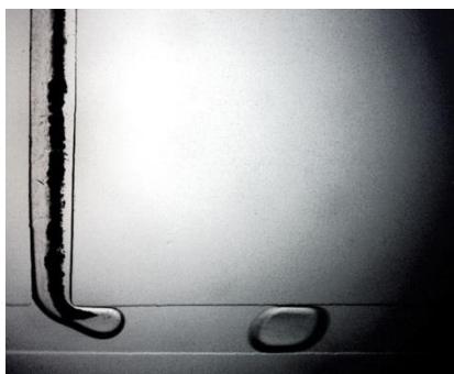
Рис.1. Формирование капли микроэмульсии в канале микрофлюидного устройства.
