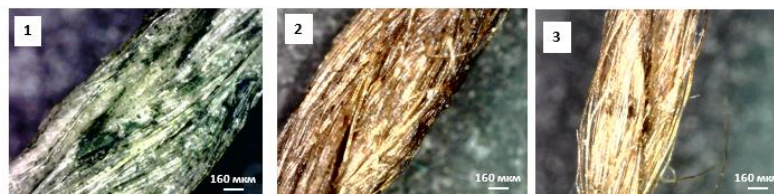
Рис.2. Микроскопические фотографии льняных волокон, обработанных полиамидом ( C = 2.4 ммоль / л) и полиаминами: 1 – ПАНИ; 2 – ППФДА; 3 – ППТД.
