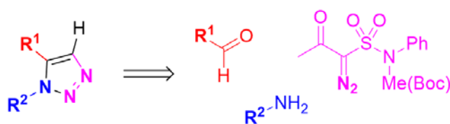
Схема 1. Ранее разработанная трёхкомпонентная реакция для получения 1,5-дизамещённых 1,2,3-триазолов
