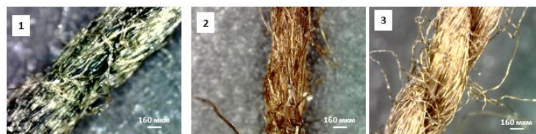
Рис.1. Микроскопические фотографии льняных волокон, обработанных полиамидом ( C = 0.5 ммоль / л) и полиаминами: 1 – ПАНИ; 2 – ППФДА; 3 – ППТД.
