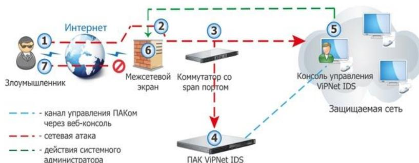
Рис.4. Подключение ViPNet IDS к каналам связи контролируемых информационных систем осуществляется по T-образной схеме
