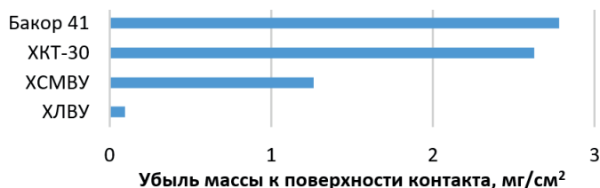
Рисунок 1. Показатели коррозионной устойчивости при статических испытаниях, рассчитанные по убыли массы к поверхности контакта
