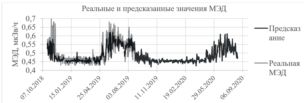
Рисунок 1. Реальные и предсказанные значения мощности эквивалентной дозы гамма-излучения
