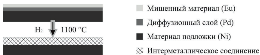
Рисунок 1. Образование слоя интерметаллического соединения методом высокотемпературного «связывающего восстановления».
