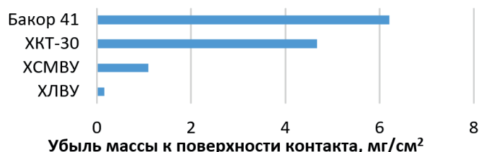
Рисунок 2. Показатели коррозионной устойчивости при динамических испытаниях, рассчитанные по убыли массы к поверхности контакта
