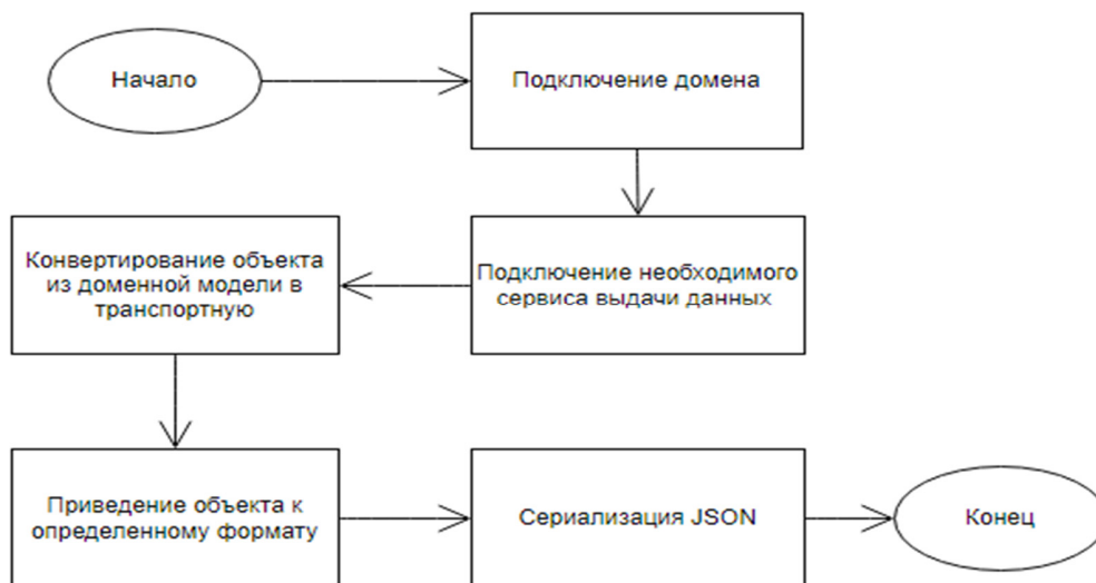
Блок-схема 1. Алгоритм работы методов-обработчиков
