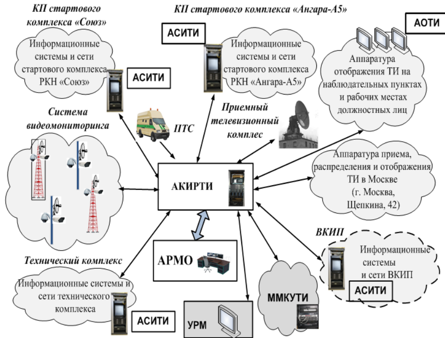
Рис. 1. Схема взаимодействия основных элементов телевизионной инфраструктуры космодрома: ВКИП-восточный командно-измерительный пункт; ПТС - передвижная телевизионная станция; КП – командный пункт; Приемный телевизионный комплекс предназначен для получения ТИ с борта пилотируемых и транспортных космических аппаратов (в том числе, с МКС); УРМ – удаленное рабочее место.
