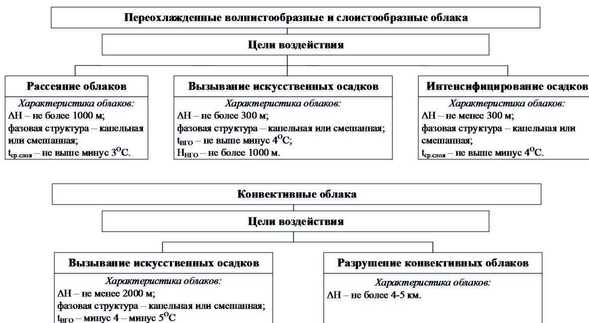
Рис. 2. Критерии пригодности к засеву переохлажденных волнистообразных, слоистообразных и конвективных облаков
