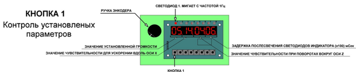
Рис. 3. Регулировки параметров устройства с помощью пульта
