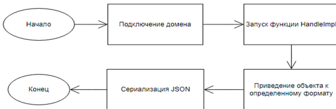
Блок-схема 3. Алгоритм работы BaseHandler
