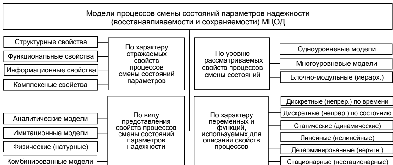
Рис. 1. Вариант классификации математических моделей для описания процесса смены состояний параметров восстанавливаемости и сохраняемости МЦОД
