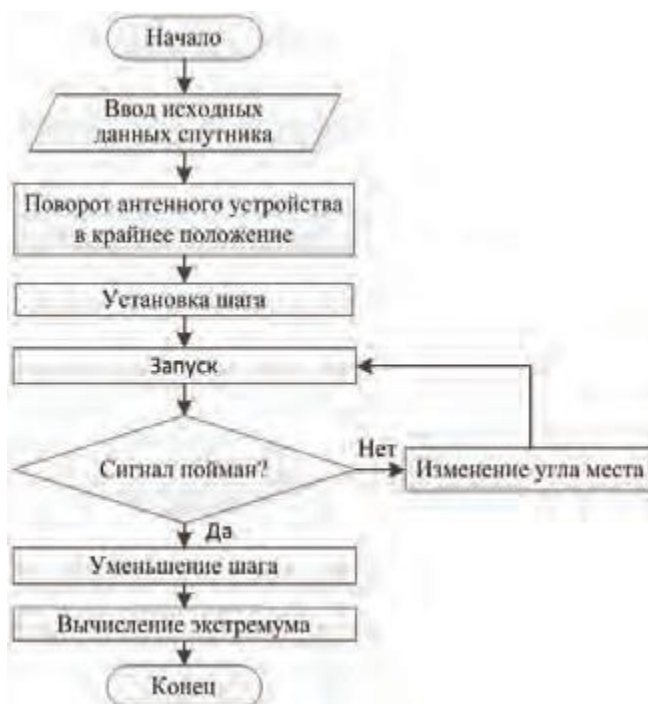
Рис. 5 Блок-схема алгоритма управления поворотом антенны
