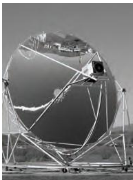
Рисунок 4 – Двигатель Стирлинга, получающий энергию от солнечной установки
