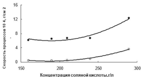
Рисунок 2 – Влияние концентрации соляной кислоты на скорость коррозии (○) и растворение оксидов (●)
