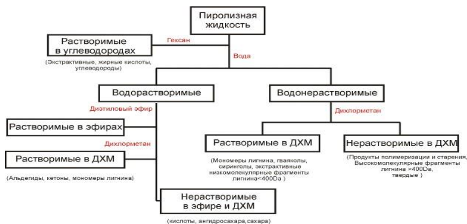
Рисунок 2 - Схема сепарации пирилизной жидкости растворителями
