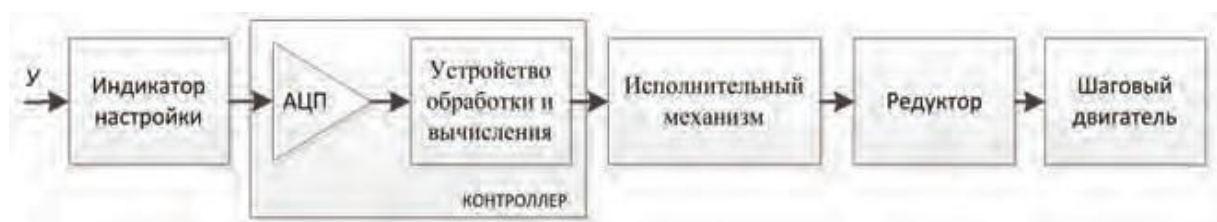
Рис. 4 Функциональная схема управления поворотом антенны
