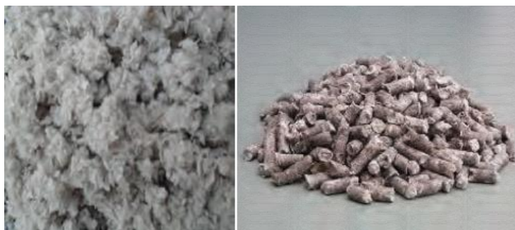
Рис 1. Стабилизирующие добавки: Армидон (волокна и гранулы)
