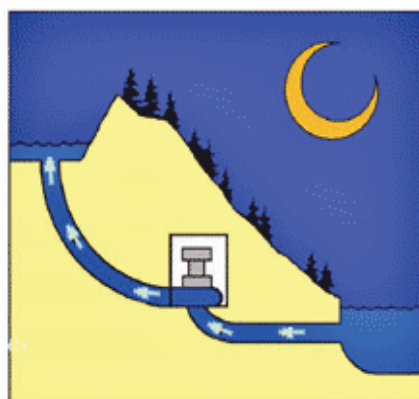
Рисунок 2 Ночь: вода накачивается в гору в резервуар для завтрашнего использования
