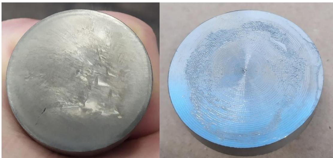
Рис. 3. Поверхность оснасток образцов для испытаний: слева оснастка с первой партии, справа оснастка со второй партии
