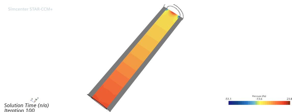
Рис. 12. Поля давлений воды в моделируемой геометрии
