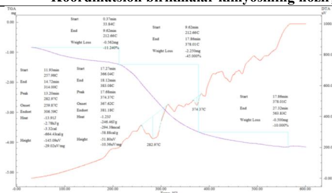
1-rasm. KFNA ning termogravimetrik derivatogrammasi (TGA) va differensial termogravimetrik analizi (DTA)
