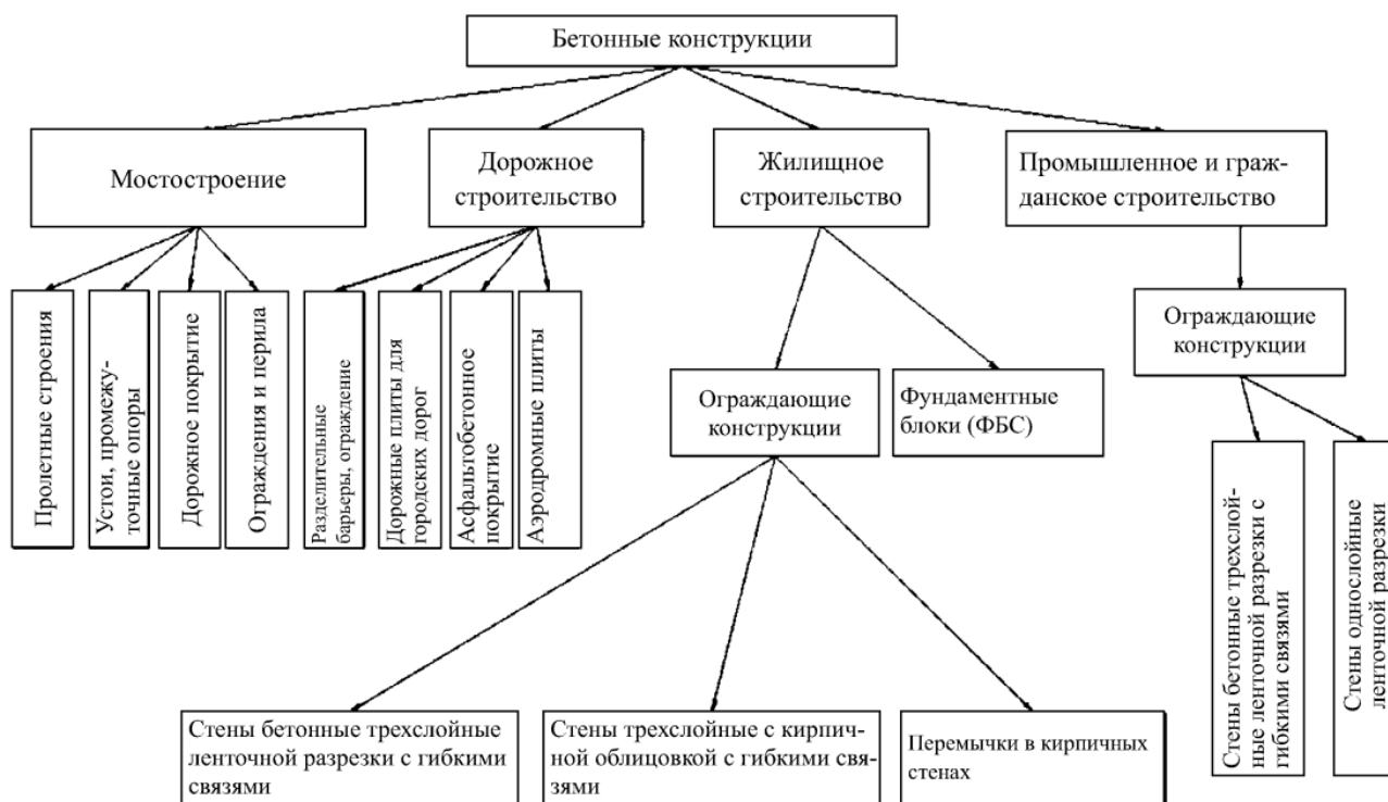
Рис. 1. Бетонные строительные конструкции с возможностью использования АНК
