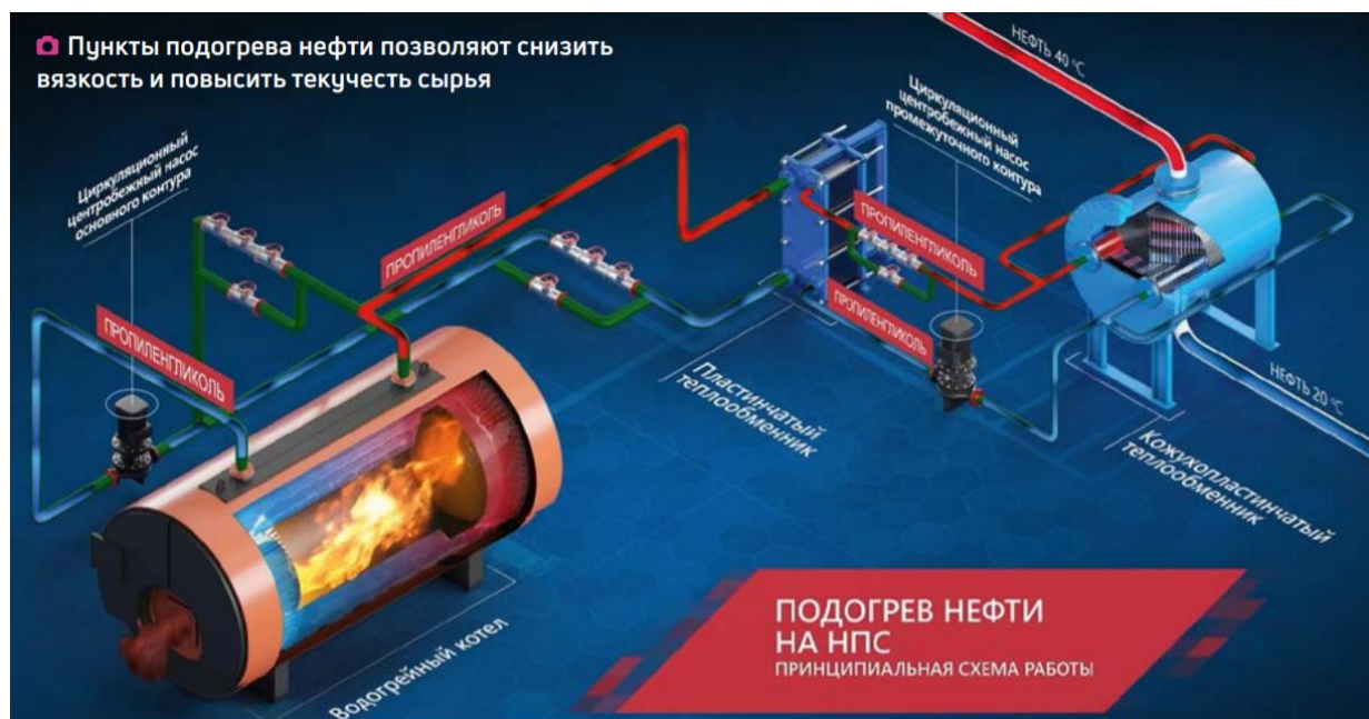
Рис. 1. Принципиальная схема работы ППН
