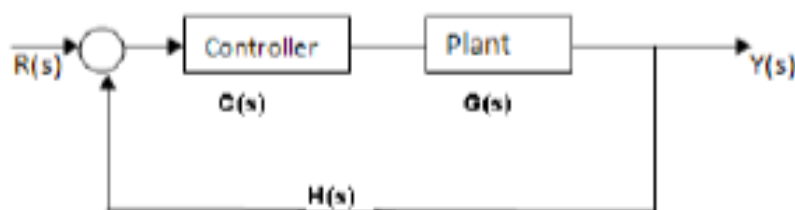
Рис. 1. Система управления с отрицательной обратной связью
