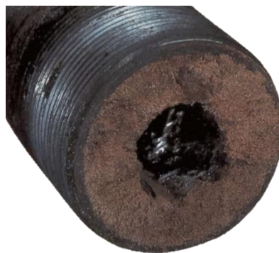
Рис. 3. Отложение парафинов на стенке трубы
