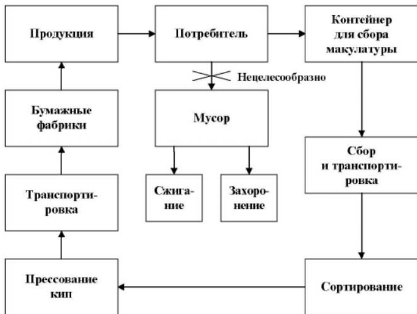
Рис. 1. Схема взаимосвязей основных звеньев в системе сбора и переработки макулатуры
