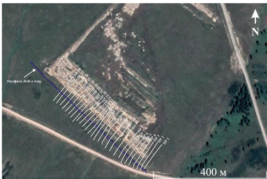
Рис.1. Схема расположения профилей электротомографии. Нарращивание длины профиля проводилось способом нагоняющей (roll-a-long), когда первый сегмент косы из 24 электродов переносится вперед по профилю.
