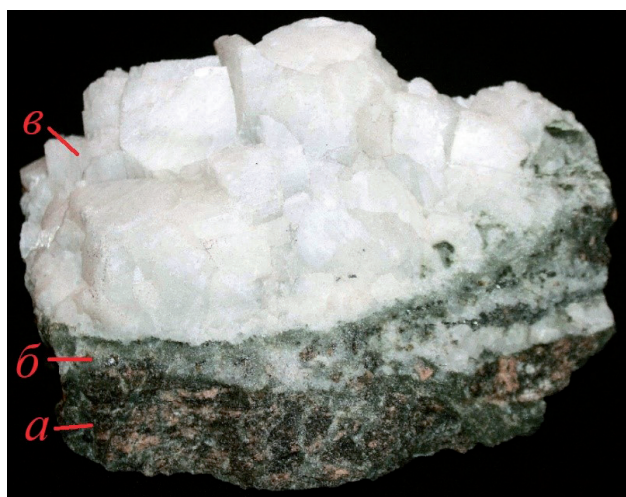
Рис. 2. Характерное строение рудной жилы (а – брекчия вмещающих пород; б – окварцованные метасоматиты; в – крупнокристаллический кальцит) Размер образца 18×12 см. Шахта «Орел» (фото: Фришман Н.И.).
