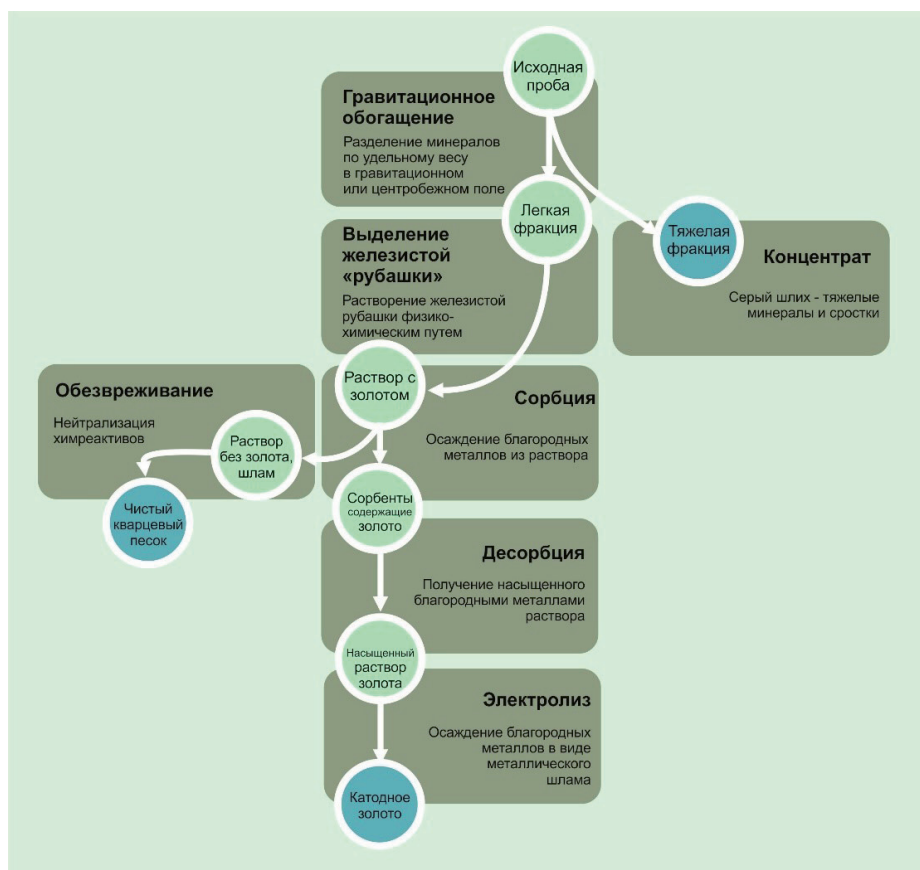
Рис. 3. Принципиальная схема обогащения ожелезненных песков аптского возраста Стебаевского месторождения.
