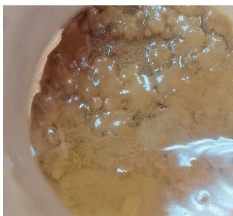
Рис. 1. Материал охристо-бурого цвета в результате растворения железистой «рубашки» лимонной кислотой.
