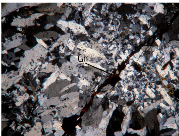
Рис. 4. Трещина, заполненная гетитом; увеличение 40×, николи параллельны.
