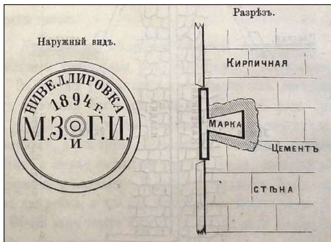
Рис. 5. Схема нивелирной марки МЗиГИ.
