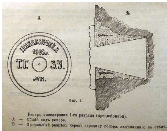
Рис. 6. Схема нивелирной марки ТГЗУ.
