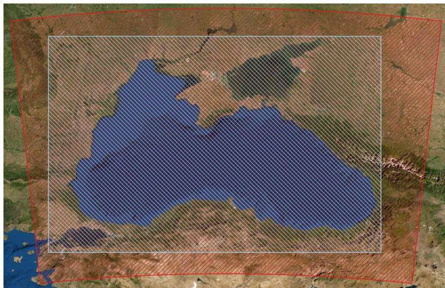
Рис 1. Расчетные области моделей INMOM (голубая штриховка) и WRF (красная штриховка) для акватории Черного, Азовского и Мраморного морей
