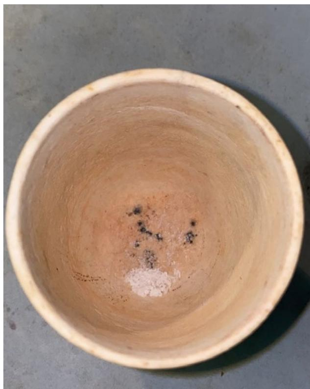
Рис. 3. Характерные этапы определения «аморфных» соединений кремния в исследуемом песчаном грунте по методу К. К. Гедройца: а) выпаренный гель кремниевой кислоты после удаления органических веществ; б) «аморфные» соединения кремния после прокаливания фильтра в муфельной печи.
