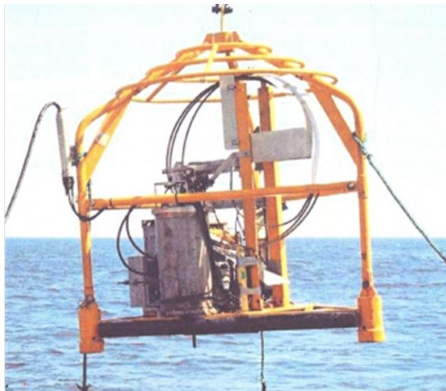
Рис. 2. Установка статического зондирования «Sea Scout»
