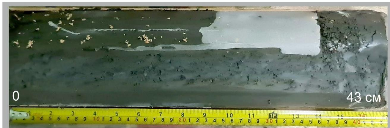
Рис. 5. Керна со станции TTR19-AR129G после раскрытия пластикового тубуса в лаборатории
