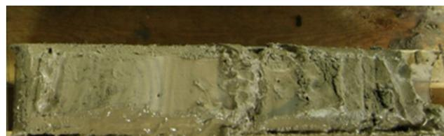
Рис. 4. Характерный вид приповерхностного слоя супеси в интервале 0,0–1,50 м
