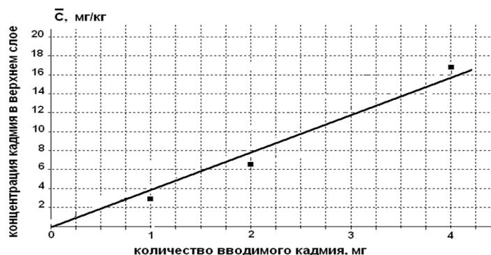
Рисунок 1 — Зависимость концентрации кадмия, поглощенного верхним слоем почвы, от количества вводимого кадмия с водным раствором в колонки
