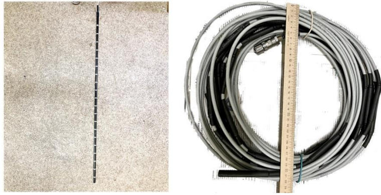
Рис 1. Внешний вид устройства термокосы
