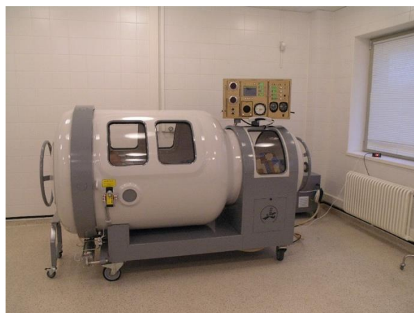
Фото 3. Одноместная кислородная барокамера БЛ 307 «Хруничев».
