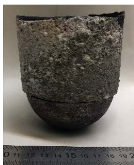
Рис. 2. - Полученный слиток с целевой лигатурой Мо-Сг и шлаком на поверхности
