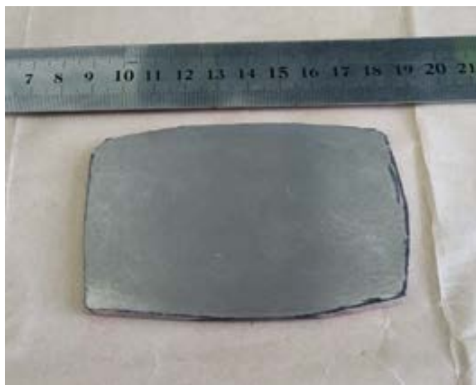
Рис. 1. Фото образца из материала TiB-40 масс.%Ti, полученного при времени задержки 25 с
