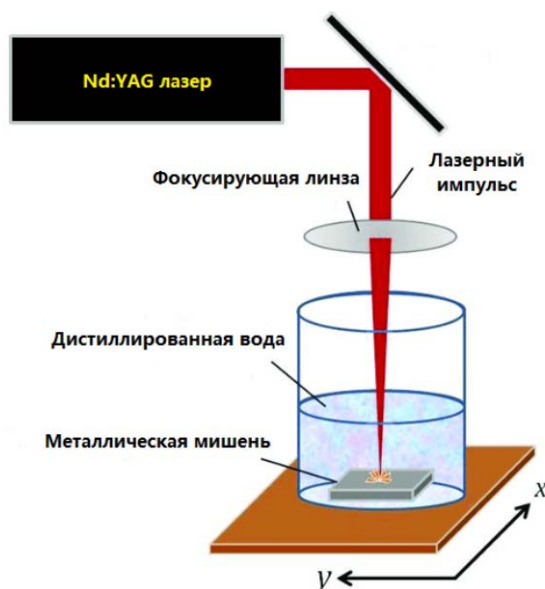
Рис. 1 - Схема процесса лазерной абляции металлической мишени в жидкой среде для получения коллоидных наносистем [4]
