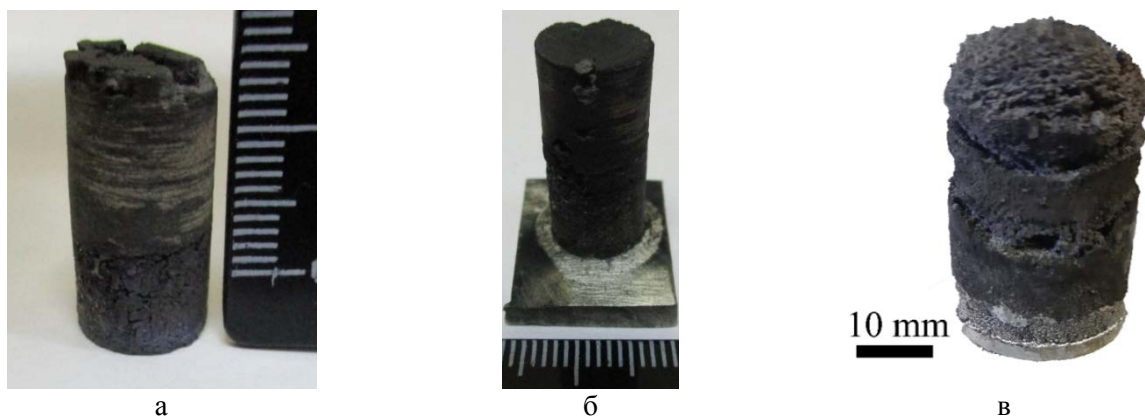
Рис. 2. Слоистые композиты: а) по схеме 1, б) по схеме 2, по схеме 3
