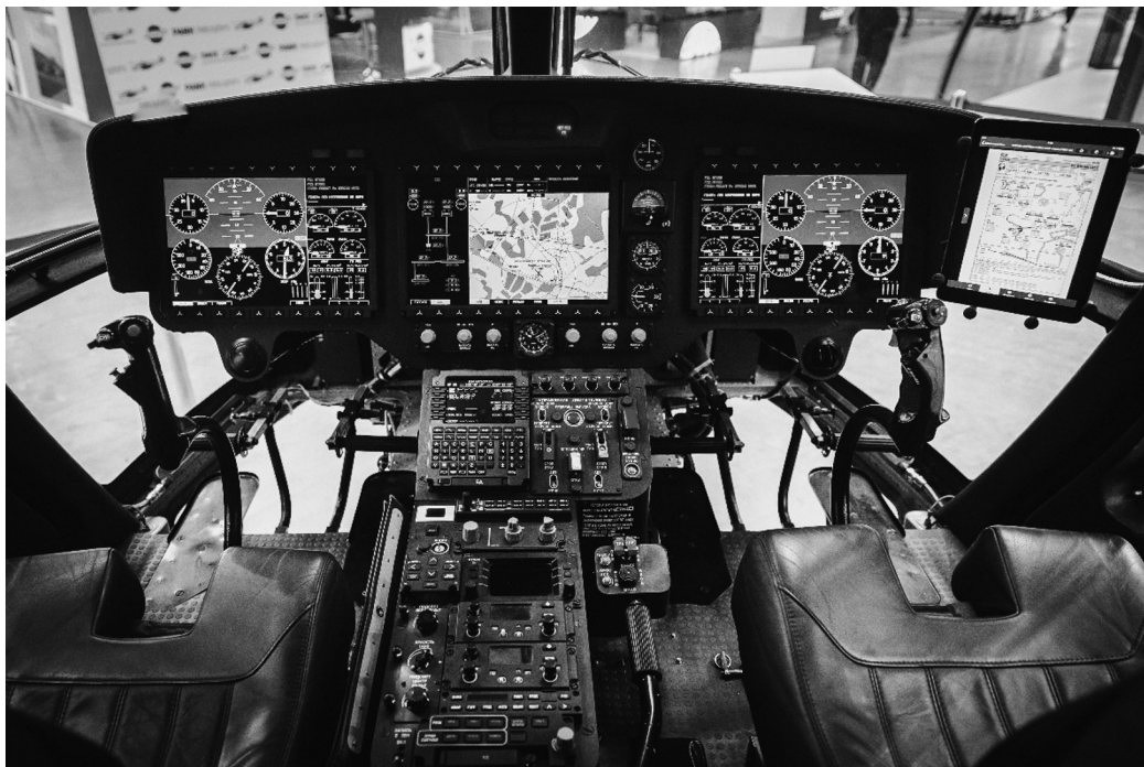
Рис. 2. Кабина вертолета АНСАТ с модернизированным БРЭО
