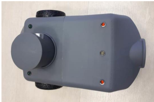
Рис. 1. Мобильный робот с установленными маркерами
