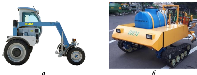
Рис. 1. Перспективные проекты МЭС разработки ВИМ: а – многофункциональное МЭС тягового класса 0,9; б – беспилотное самоходное гусеничное шасси
