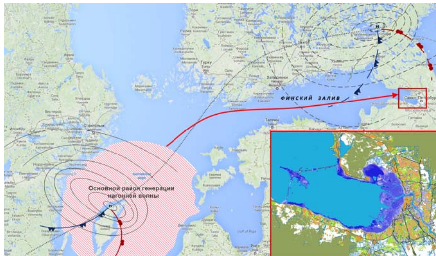
Рис. 7. Схема распространения нагонной волны и возможная траектория порождающего ее циклона, приводящего к затоплению берегов Невской Губы
