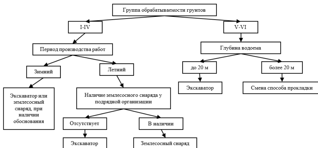
Рисунок 1. Блок-схема выбора способа разработки траншеи для судоходных водоемов [2]
