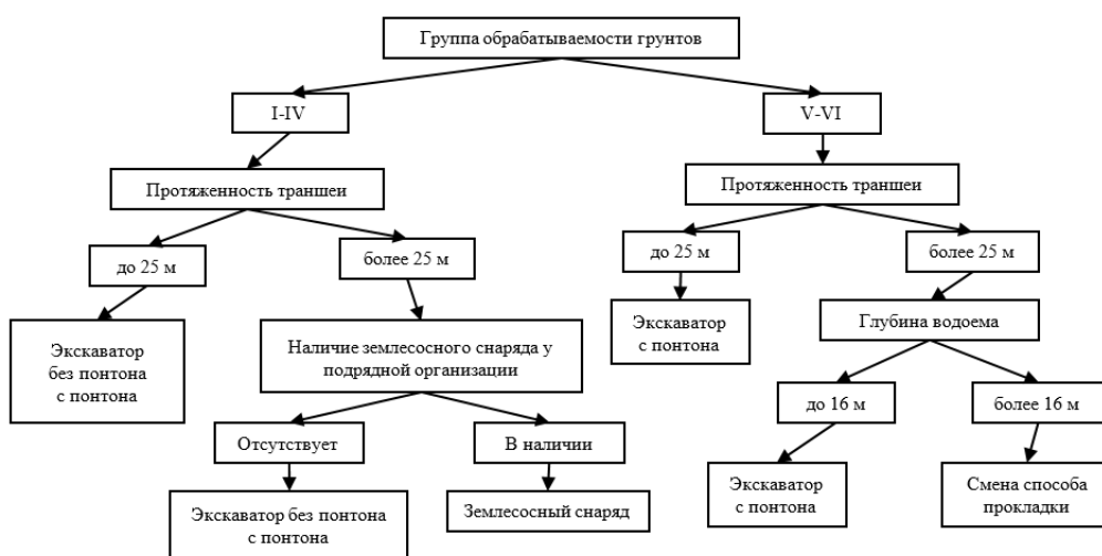
Рисунок 2. Блок-схема выбора способа разработки траншеи для несудоходных водоемов [2]
