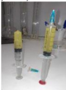
Рис. 2. Разбор шприцов с полученным криогелем
