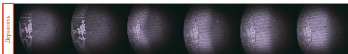
Рис. 1. Зависимость пропускания образца от времени при охлаждении (светлые области соответствуют орторомбической фазе, темные – тетрагональной фазе).
