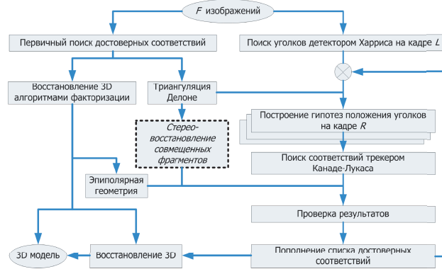
Рис. 1. Схема системы восстановления трехмерных сцен
