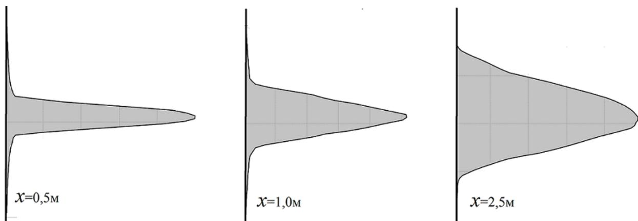
Вид приведенных зависимостей позволяет допустить существование подобия. Для нахождения автомодельных переменных использовался анализ размерностей, с помощью которого получен универсальный для всех сечений закон автомодельного расширения струи в усложнённой физической обстановке.
