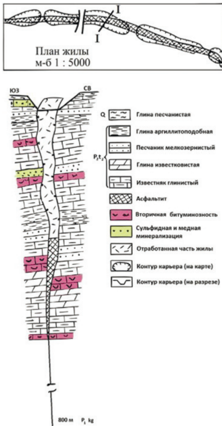
Рис. 1. План и геологический разрез жилы Садкинского месторождения асфальтита [Овчинников и др., 2015]
