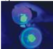
Рисунок 1. Порошок стекла, содержащего кристаллы ГП \text{CsPbBr}_3 при облучении УФ лампы
