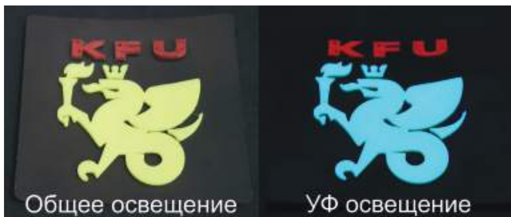
Рисунок 1. Эмблема Казанского федерального университета, напечатанная методом послойного наплавления с использованием двух композитов PP/МНР-QD
