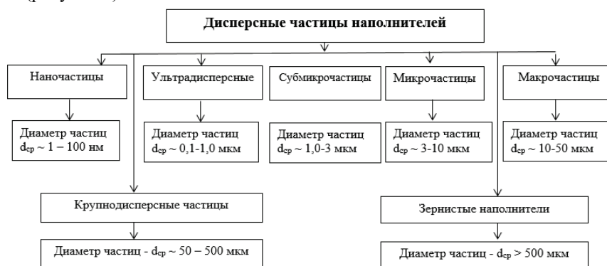
Рисунок 1. Классификация дисперсных частиц наполнителей по размерам для создания ДНПКМ
