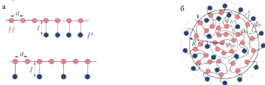
Рисунок 1. Строение сополимеров с гидрофобным и амфифильным блоками и с равномерным распределением амфифильных звеньев (а) и строение глобулы с гидрофобным ядром (б).
